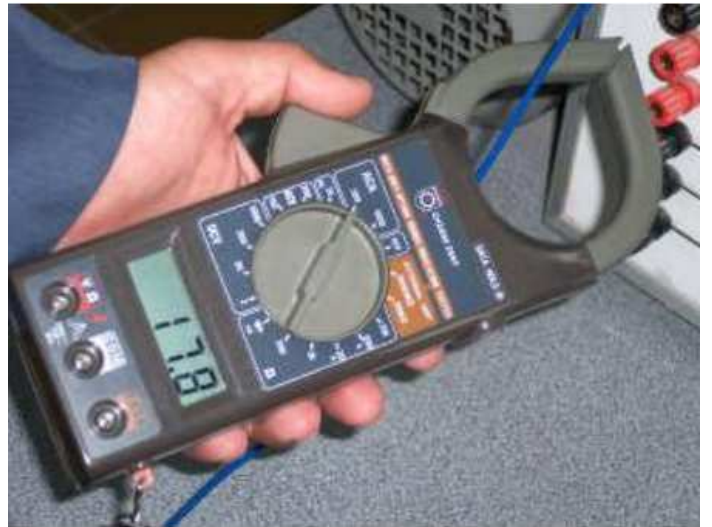
Pens ampermetre ile akım ölçmek
